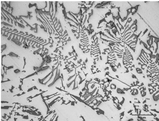
Fig. 3 Intermetallic phase \alpha -AlFeMnSi
